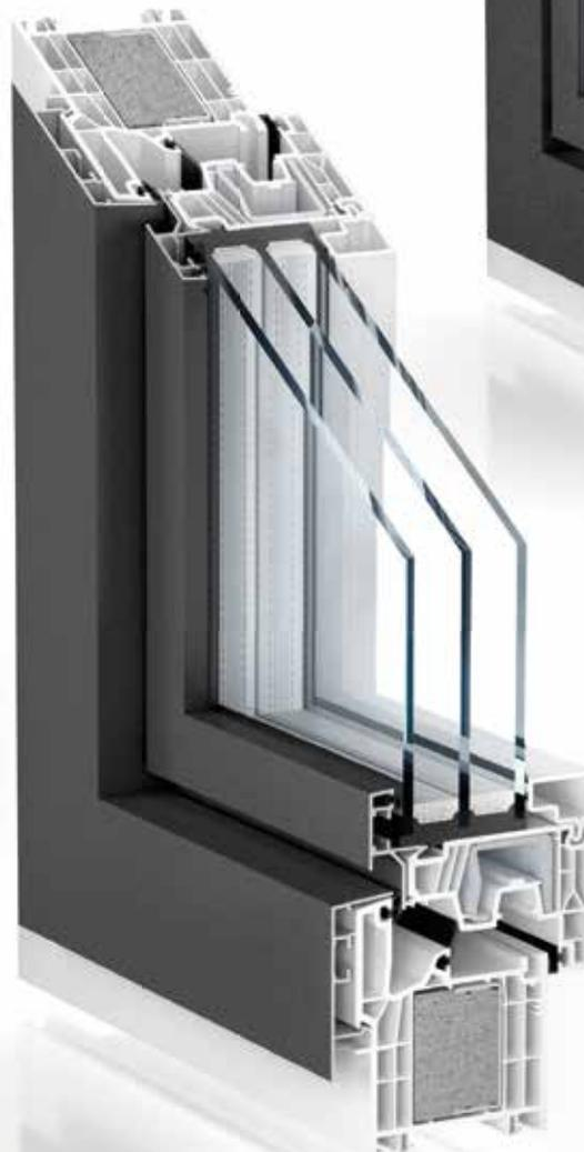
У варіанті «зі зміщенням» стулка розташована дещо зміщеною за рамою зовні. Зі сторони приміщення стулка знаходить на раму при закриванні. Тут також доступна версія в одній площині. Завдяки середньому контуру ущільнення в рамі значення  $U_f$  сягає  $1,0 \text{ Вт} / (\text{м}^2 \cdot \text{К})$ .
