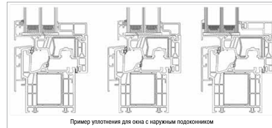
Пример уплотнения для окна с наружным подоконником
